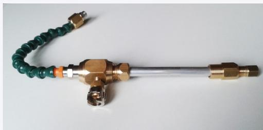
Gli ugelli della **serie TH** sono espressamente progettati per ottenere uno sbalzo termico significativo quando l'aria compressa a temperatura ambiente viene canalizzata nell'ingresso dell'ugello e l'abbassamento di temperatura è ottenuta nell'aria che fuoriesce dal dispositivo (temperatura compresa tra 15 ° C a 30 ° C a seconda di molti fattori, come la pressione di ingresso e il modello di ugello).
